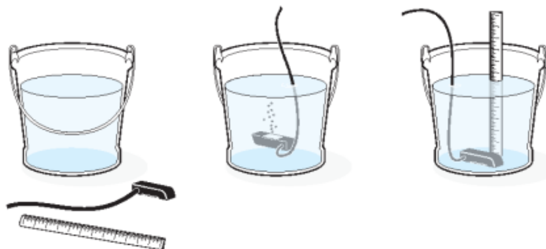
图 18 校准浸入式面积/速率传感器
